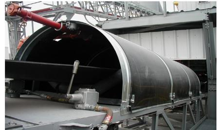
Las cubiertas de HDPE (polietileno Alta Densidad) están específicamente diseñadas para condiciones de zonas químicamente complejas; áreas de alta corrosión con inmejorables propiedades mecánicas, su impermeabilidad les permiten actuar como barrera a ambientes agresivos. Su bajo peso (2,9 kg/m<sup>2</sup>); alta fuerza tensil y alta resistencia a impactos permiten garantizar una larga duración.
